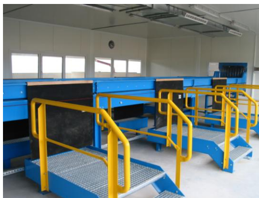
Przenośnik i stanowiska sortownicze
